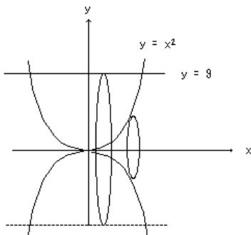
$y = x^2$  と  $y = 9$  の交点を求めるとき,  $x^2 = 9$  より,  $(-3, 9)$  と  $(3, 9)$  となる. 回転軸に垂直な平面で切断すると, その断面はワッシャーになる. よって,  $x$  軸上の任意の点  $x$  における断面積  $A$  は
