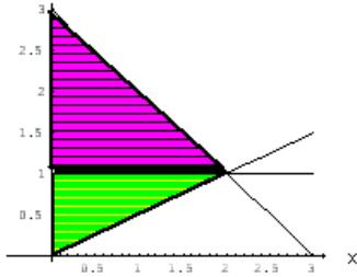
$\int_0^2 \int_{\frac{x}{2}}^{3-x} f(x, y) dy dx$  は縦線集合として、累次積分が作られているので、これを横線集合として行なえばよい。
